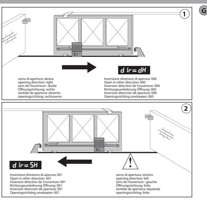
Nel passaggio di configurazione logica da apertura destra/sinistra, non invertire il collegamento originale dei morsetti 42-43.
